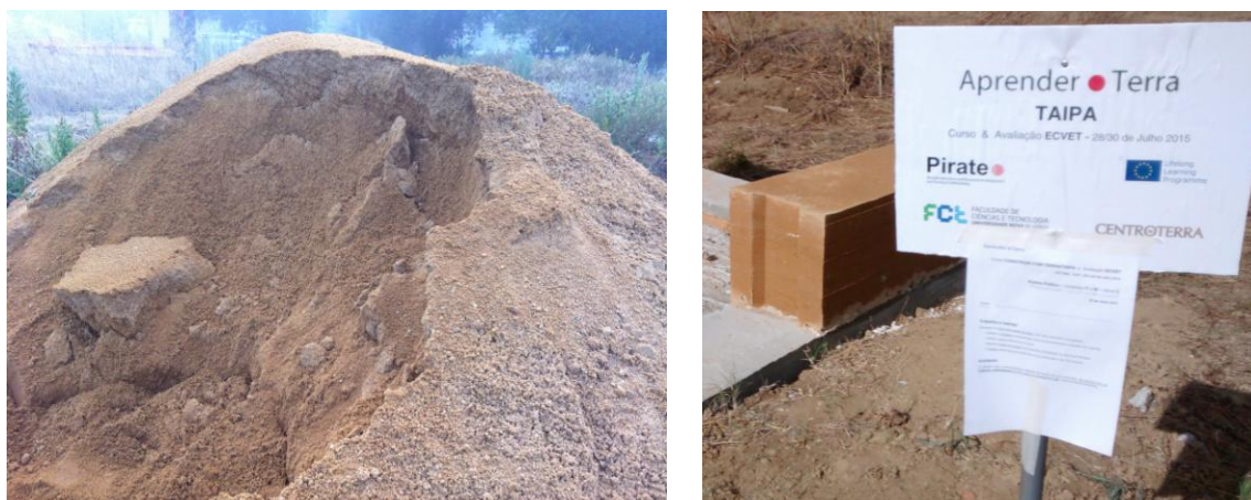
Figura 3. Terra utilizada para a formação e avaliação (difícil de utilizar para a técnica da taipa) e elemento em taipa realizado na formação por alguns formandos.
