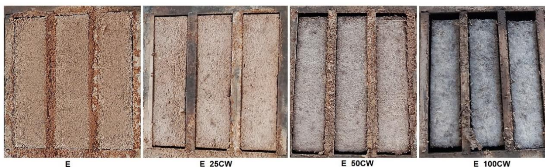
Figura 2. Cores e retração visível nos provetes prismáticos das argamassas de terra (Crédito: Tânia Santos).
